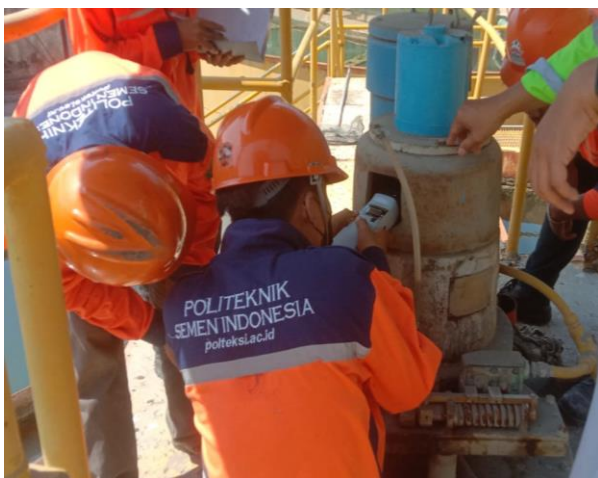
Gambar 2. Pemeriksaan putaran rpm agitator
